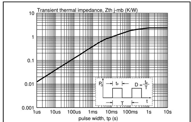
Fig.9. Transient thermal impedance per diode
