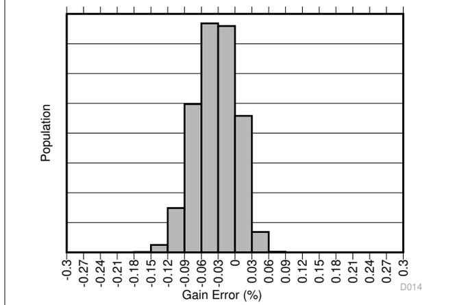
**Figure 6-6. Gain Error Production Distribution**
