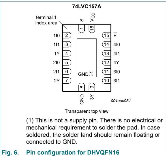
Fig. 6. Pin configuration for DHVQFN16
