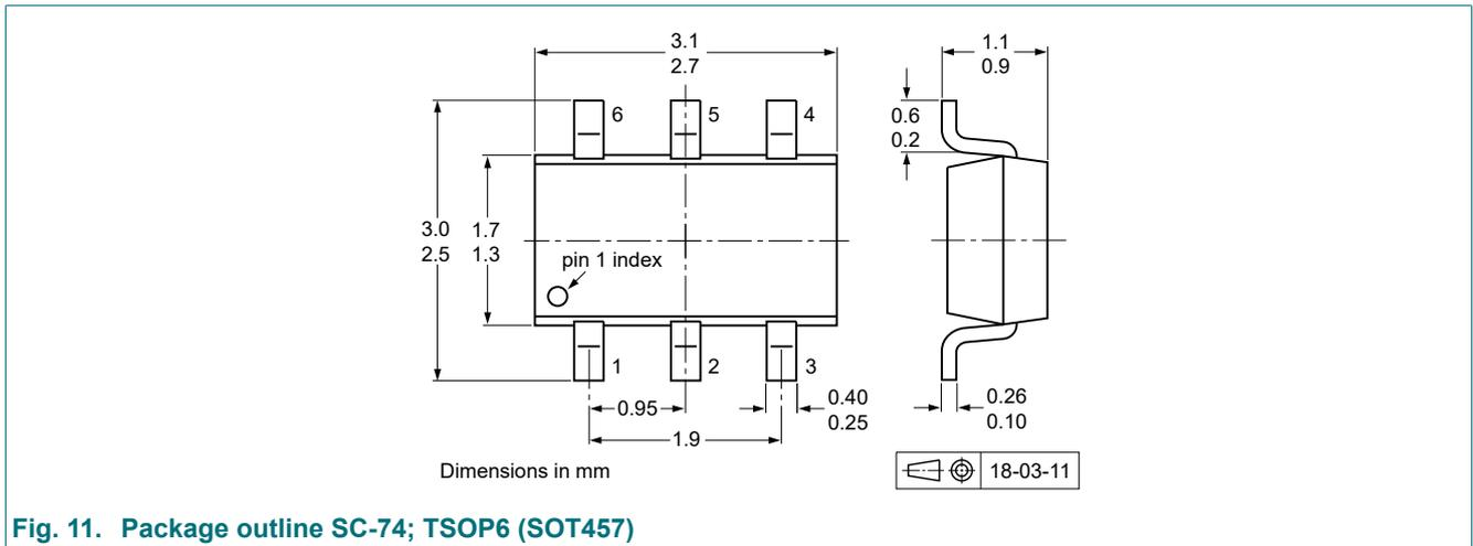
Fig. 11. Package outline SC-74; TSOP6 (SOT457)
