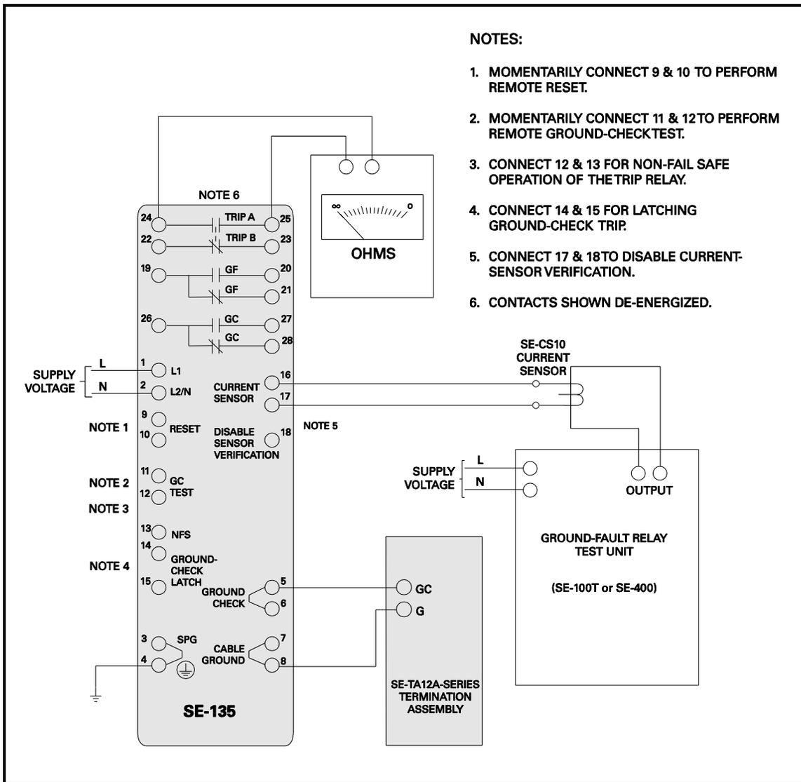
FIGURE 16. Ground-Fault-Test Circuit.
