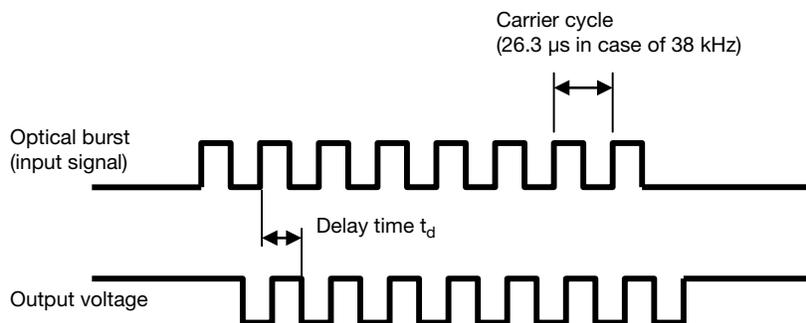
Fig. 1 - Testsignal
