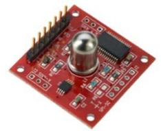
**Dual Axis SPI Inclinometer**
