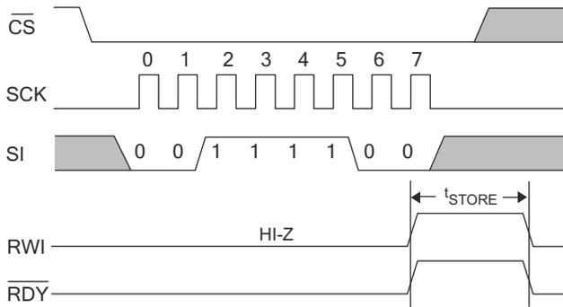
Figure 24. Software RECALL Cycle<sup>[15]</sup>
