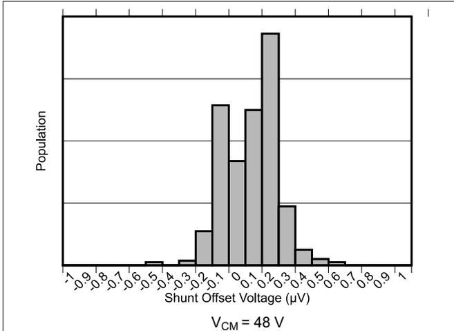
Figure 6-2. Shunt Input Offset Voltage Production Distribution
