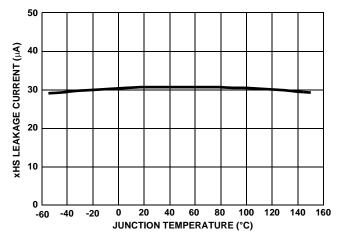
FIGURE 12. HIGH VOLTAGE LEAKAGE CURRENT
