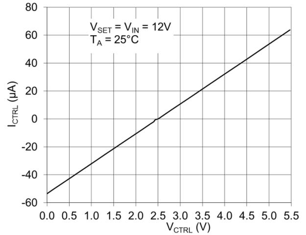
Figure 2  $I_{CTRL}$  vs.  $V_{CTRL}$
