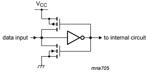
Fig. 4. Bus hold circuit
