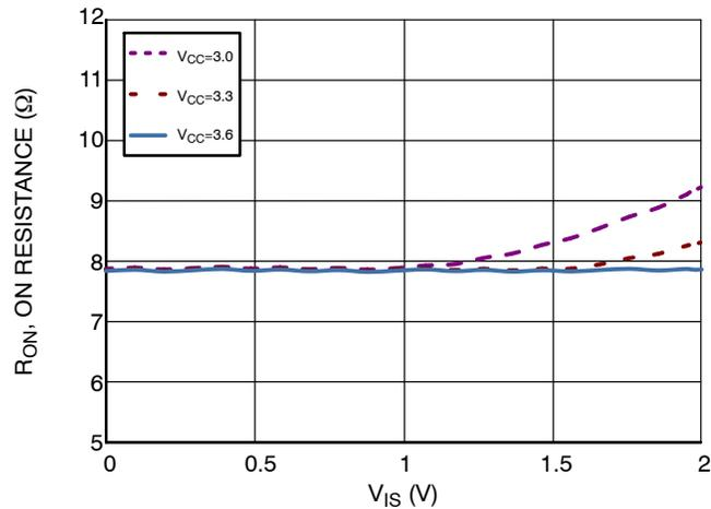
Figure 12. RON vs. V<sub>IS</sub>
