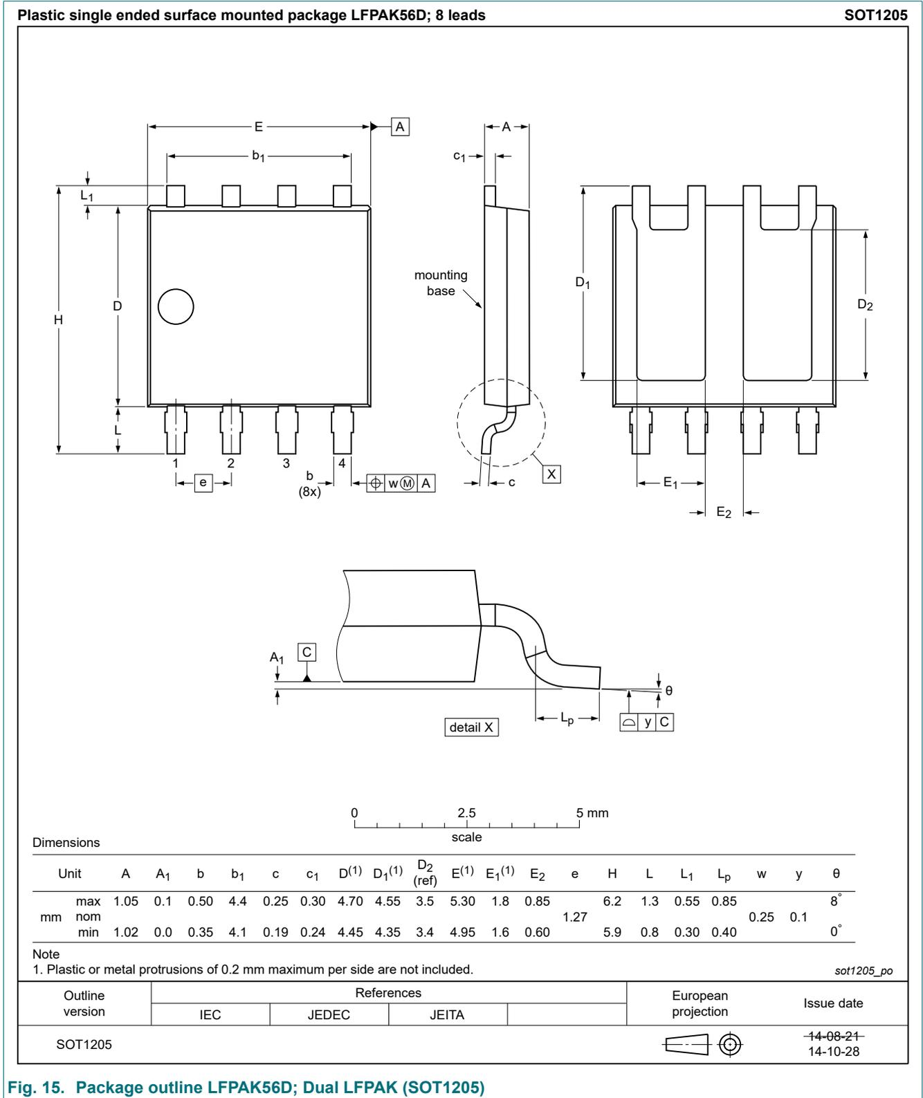
Fig. 15. Package outline LPAK56D; Dual LPAK (SOT1205)
