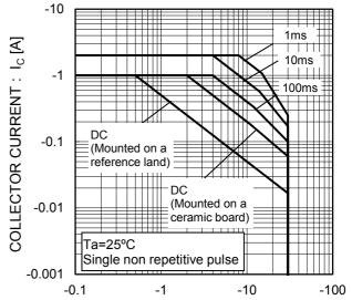
COLLECTOR TO EMITTER VOLTAGE :  $V_{CE}\ [V]$
