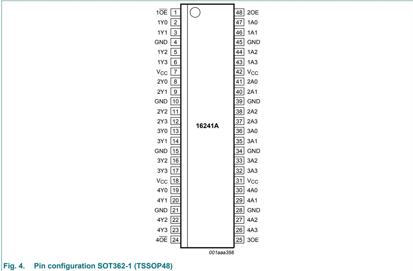
Fig. 4. Pin configuration SOT362-1 (TSSOP48)
