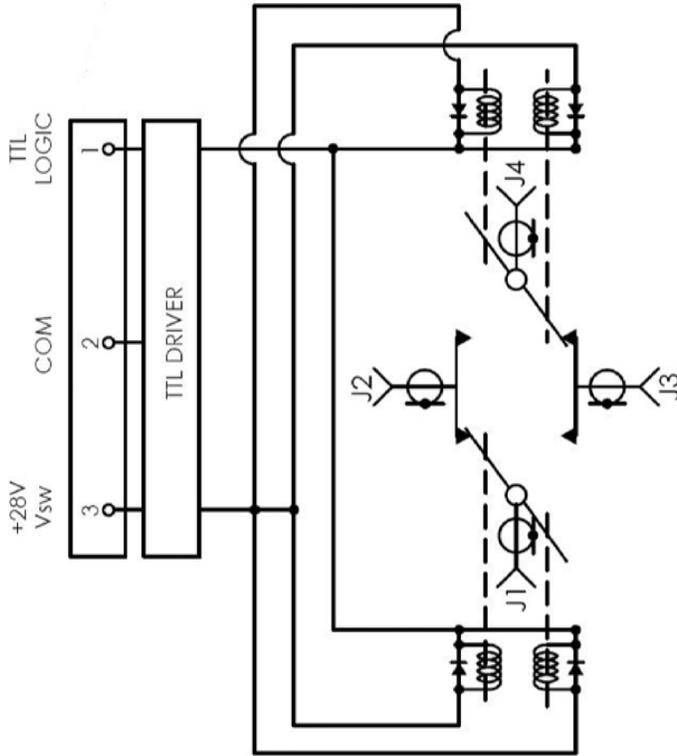
**SCHEMATIC SHOWN IN FAILSAFE POSITION**
