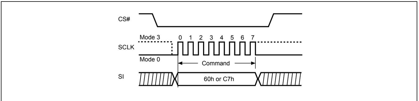
**Figure 78. Chip Erase (CE) Sequence (QPI Mode)**
