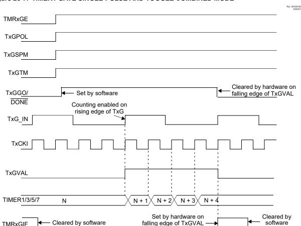
Figure 26-7. TIMER1 GATE SINGLE-PULSE AND TOGGLE COMBINED MODE
