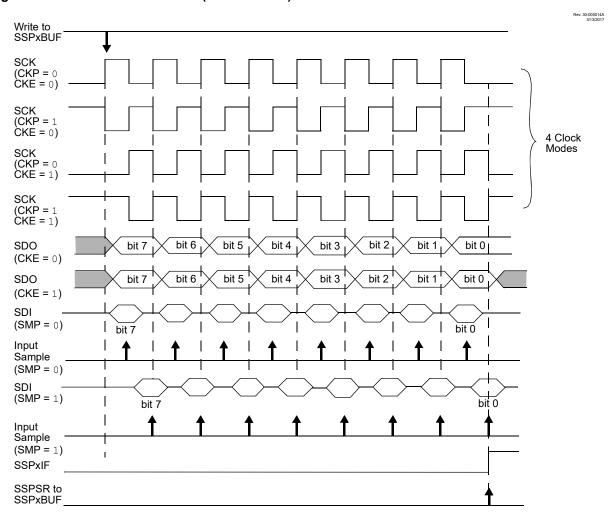
Figure 35-4. SPI Mode Waveform (Master Mode)
