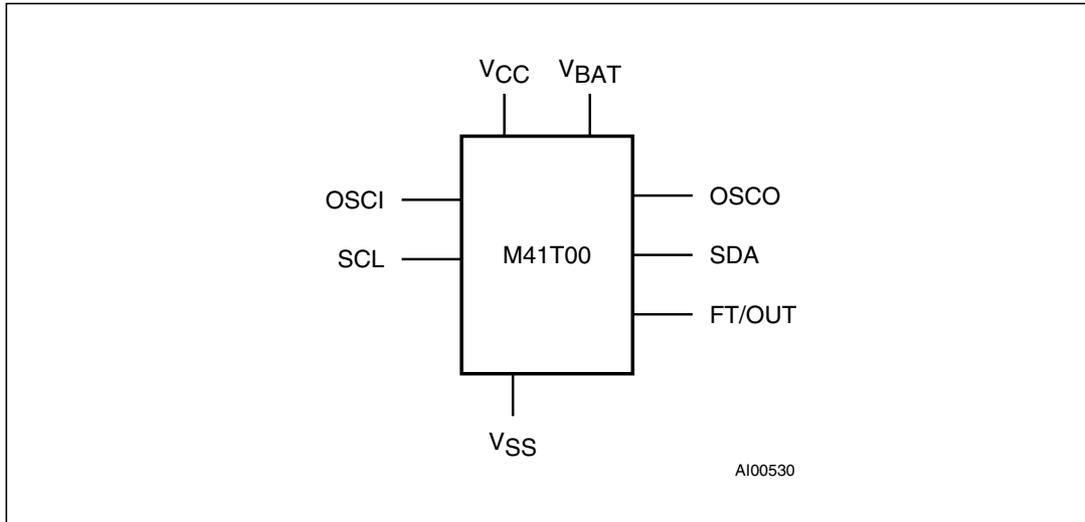
**Figure 2. SOIC connection**
