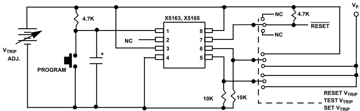
FIGURE 4. SAMPLE V<sub>TRIP</sub> RESET CIRCUIT
