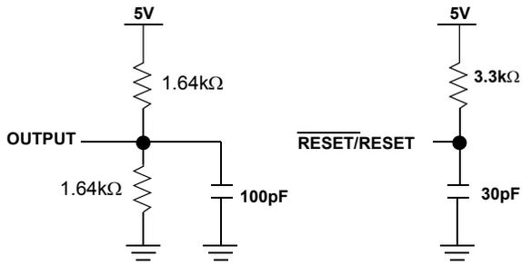
FIGURE 10. EQUIVALENT A.C. LOAD CIRCUIT AT 5V  $V_{CC}$
