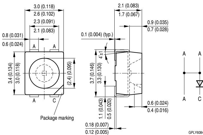
**Approximate Weight:** 30 mg**Gewicht:** 30 mg**Mark:** bevelled edge (Cathode)**Markierung:** abgeschrägte Ecke (Kathode)
