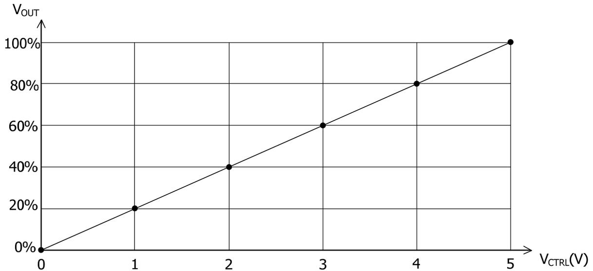
Figure 9. V<sub>CTRL</sub> vs. V<sub>OUT</sub>
