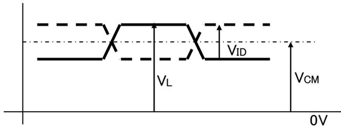
5)  $V_{CM}$  : LVDS Common mode voltage ( $V_{CM}=1.25V$ )
