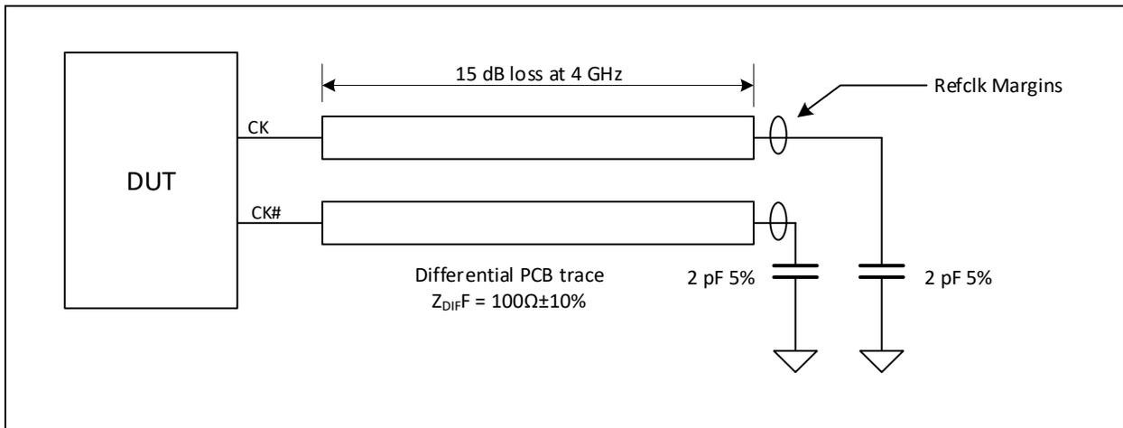
**Figure 19. Test Circuit**
