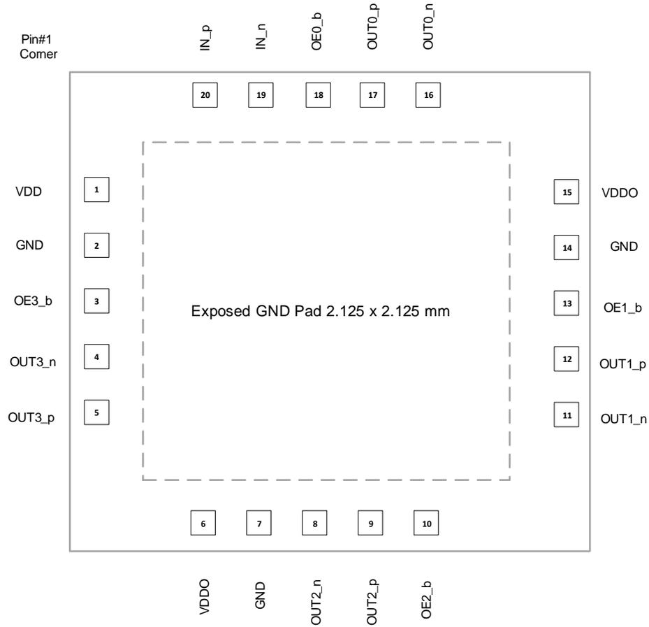
**Figure 2. Pin Diagram**
