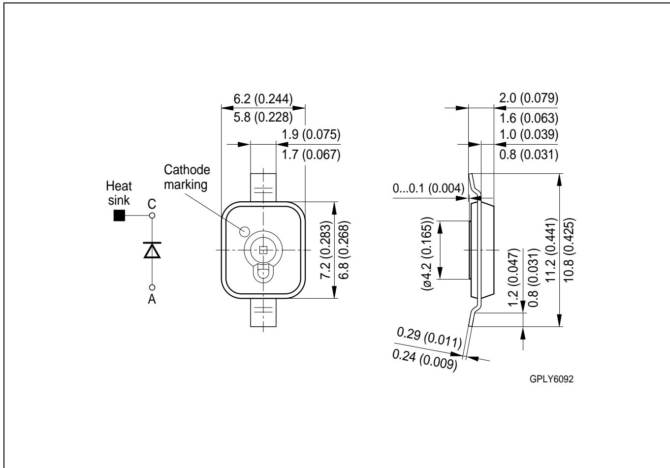
Maße werden wie folgt angegeben: mm (inch) / Dimensions are specified as follows: mm (inch).
