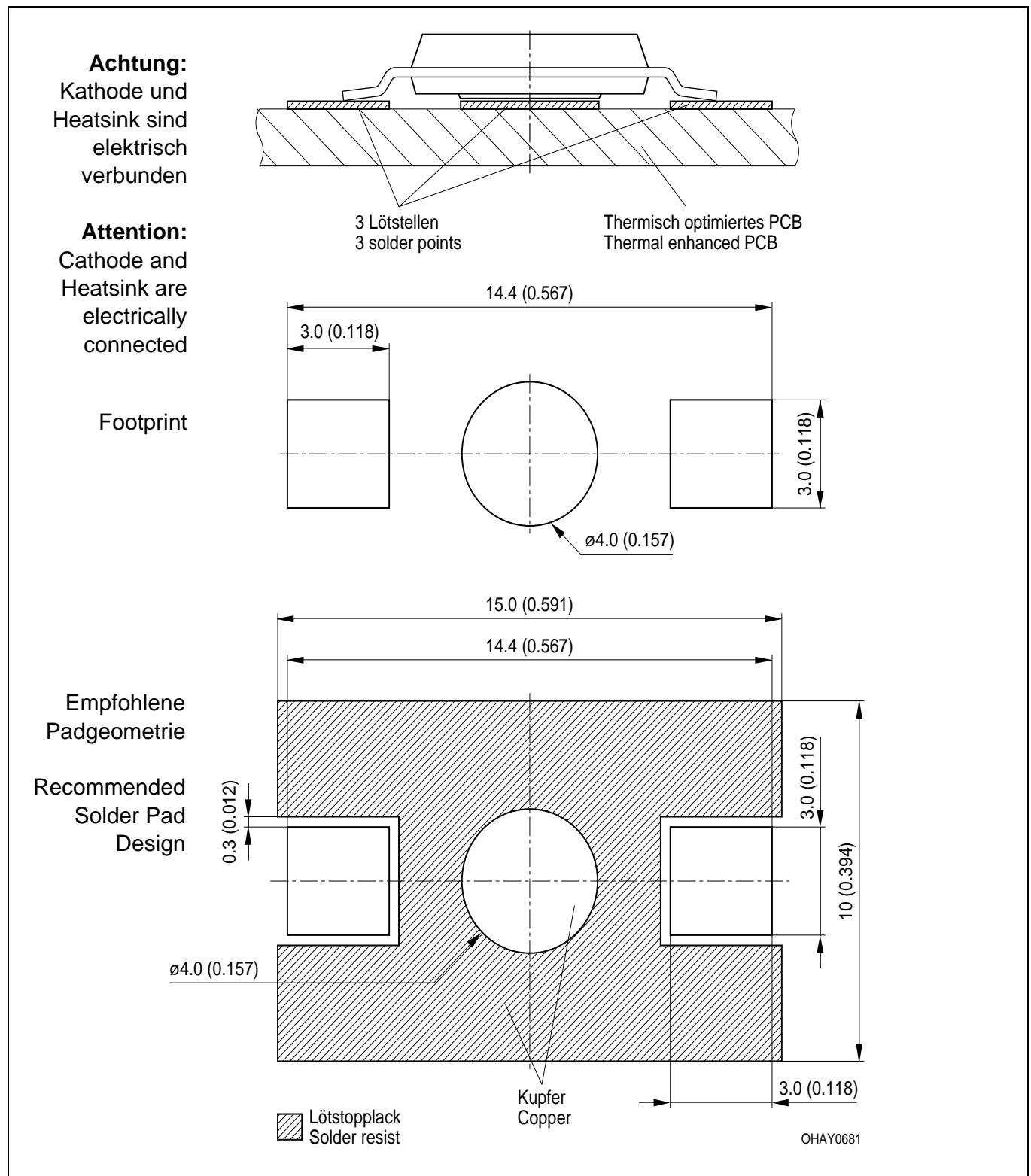
Maße werden wie folgt angegeben: mm (inch) / Dimensions are specified as follows: mm (inch).
