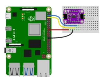
Pi 3V to sensor VIN (red wire)
