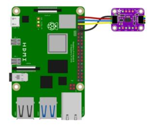
Pi 3V to sensor VIN (red wire)
