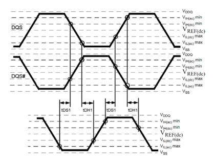
Figure 23. Single-ended input waveform timing - tDS1 and tDH1
