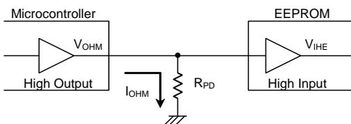
$$R_{PD} \geq \frac{V_{OHM}}{I_{OHM}} \quad (3)$$
