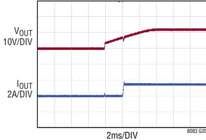
V<sub>IN</sub> = 12V, V<sub>OUT</sub> = 12V, f<sub>SW</sub> = 1MHz, 1.5A
