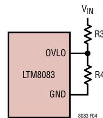
Figure 5. V<sub>IN</sub> Overvoltage Lockout (OVLO)
