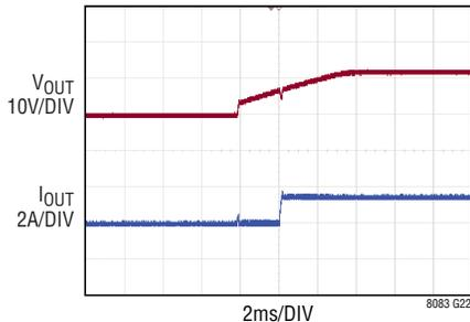
V<sub>IN</sub> = 36V, V<sub>OUT</sub> = 12V, f<sub>SW</sub> = 1MHz, 1.5A
