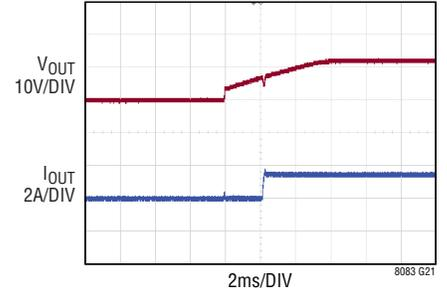
V<sub>IN</sub> = 24V, V<sub>OUT</sub> = 12V, f<sub>SW</sub> = 1MHz, 1.5A
