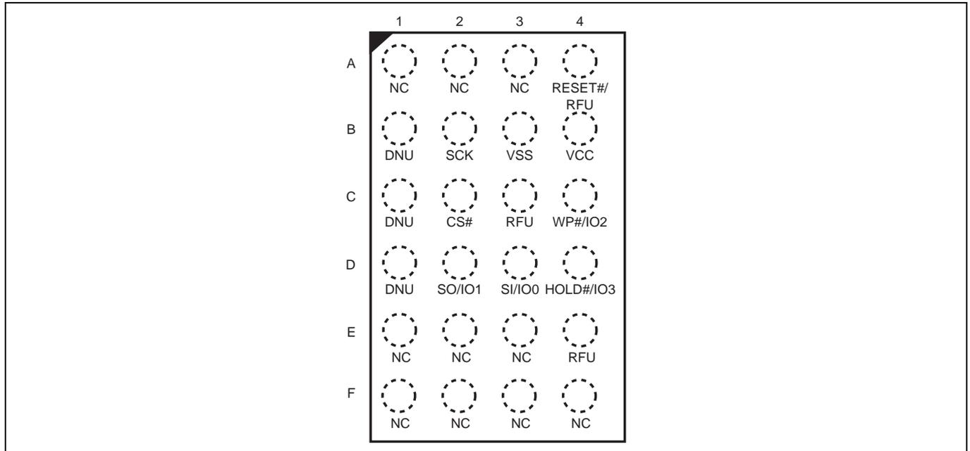
**Figure 42** 24-ball BGA, 4 x 6 ball footprint (FAC024), top view<sup>[31]</sup>
