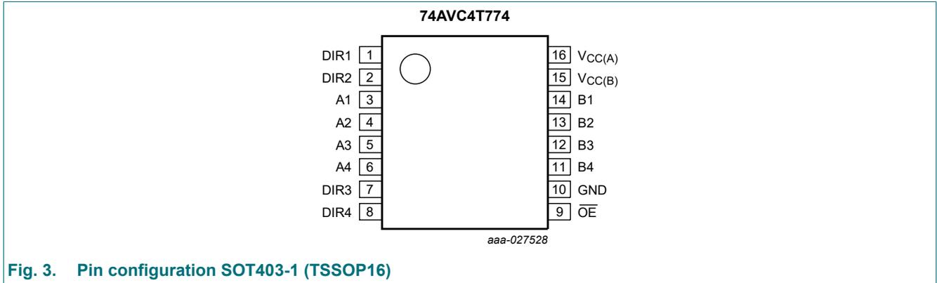
Fig. 3. Pin configuration SOT403-1 (TSSOP16)
