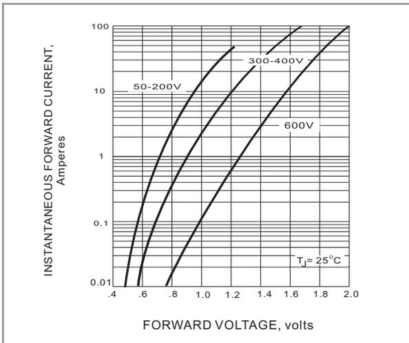
**Fig. 3 FORWARD CHARACTERISTICS**
