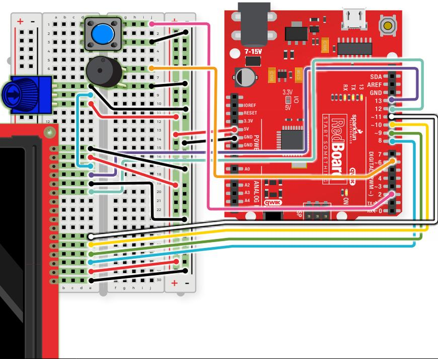
◆ 5V to 5V    ◆ GND to GND(-)    ◆ D8 to E28    ◆ D9 to E27
