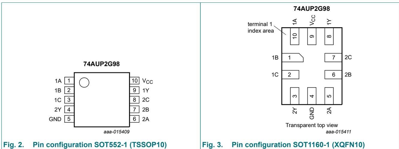
Fig. 2. Pin configuration SOT552-1 (TSSOP10)
